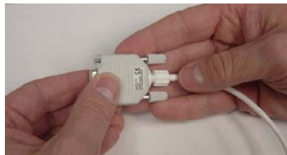
Rysunek 26. Podłączanie czujnika do przewodu ciśnieniowego
