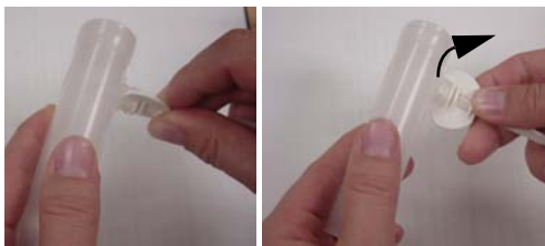
Rysunek 25. Podłączanie ustnika do przewodu ciśnieniowego
