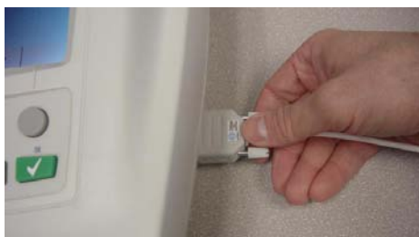
Rysunek 27. Podłączanie czujnika do portu spirometru
